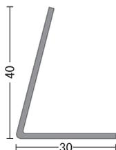
床面と壁型枠から漏れるノロ・ミルク止めに。自由に釘打ち出来ます。
